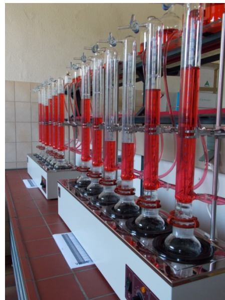
Aufbau einer Untersuchung zur Gasbildungsrate
