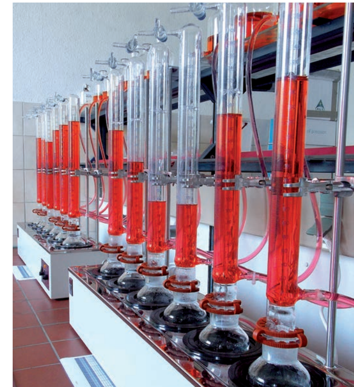
Aufbau einer Untersuchung zur Gasbildungsrate
